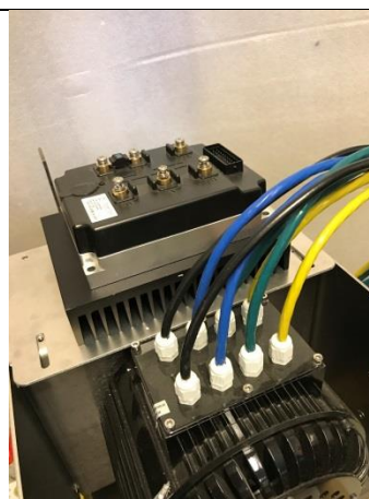
Kylfläns och styrdon avsett att monteras på S-drev med eller utan fläkt.
