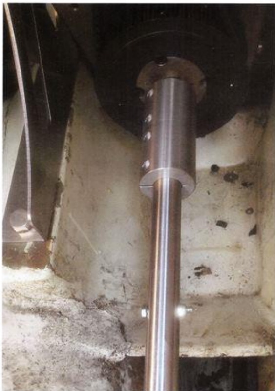
Akslen monteret på motor. Bemærk bolten, der skal hindre akslen i at glide ud, hvis den løsner sig fra motoren.
