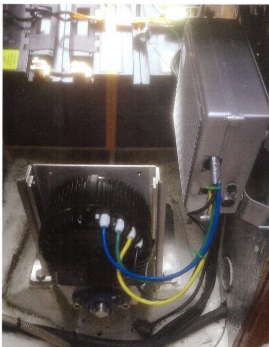
Færdigmonteret motor. Styreboksen til højre i billedet, hvor regulator tilkobles, når den skal bruges.
